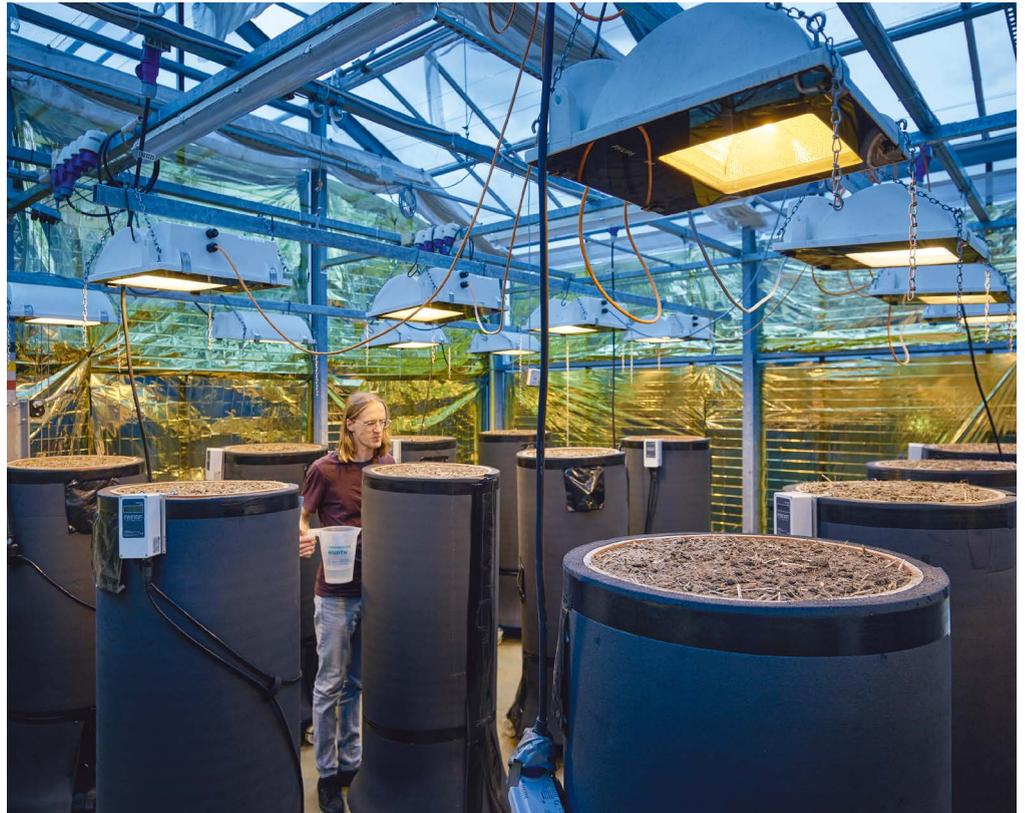
Studie an der Universität Halle-Wittenberg: Heizplatten in den Gefäßen simulieren die Wärmestrahlung der Erdkabel.
