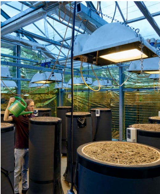
Studie an der Universität Halle-Wittenberg: Heizplatten in den Gefäßen simulieren die Wärme der Erdkabel.
